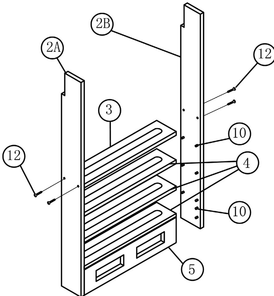
Schritt 2: Montage des unteren Brettes.
