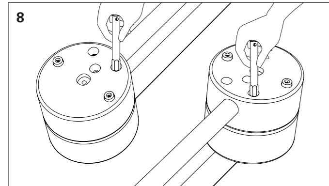
**Achtung!** Durch das Spannen der Slackline neigen sich die Rechteckbügel wechselseitig. Beim Anziehen immer darauf achten, dass der Steckschlüssel noch auf die Langmutter aufgesteckt werden kann.
