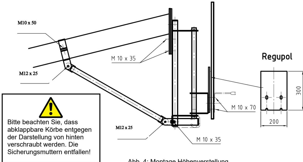
Abb. 4: Montage Höhenverstellung (Schraubengrößen)
